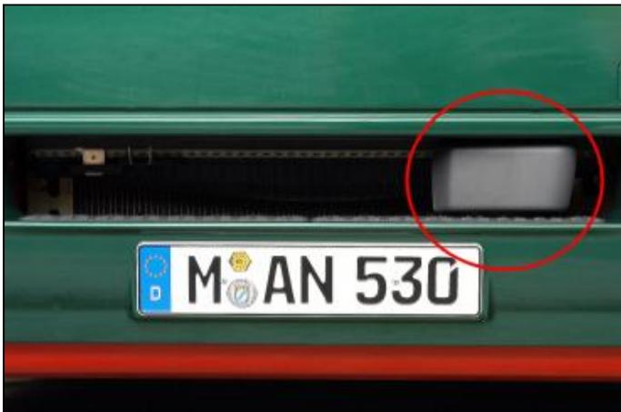
Abbildung 12: ACC-Sensor im Kühlluft einlass [www.MAN.de]
