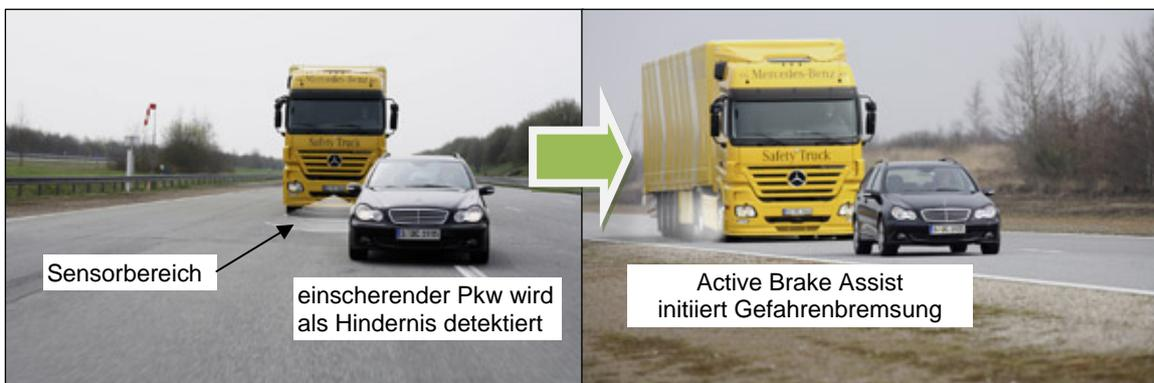
Abbildung 43: Active Brake Assist für Lkw im Einsatz (Darstellung angepasst [Daimler, 2006])
