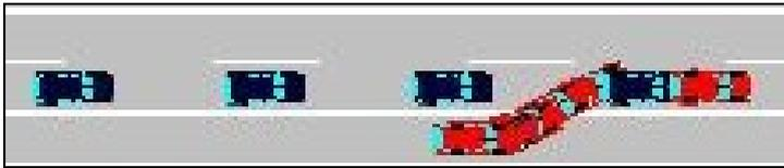
Abbildung 65: Situationsdarstellung "Auffahren auf ein ausparkendes Fahrzeug" in PC-Crash
